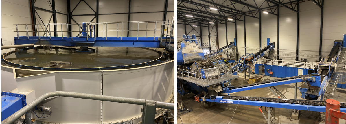
Bildetekst: Til venstre: Flotasjonsbassenget hvor organisk separeres ut. Til høyre: Renseanlegget separerer grusen etter størrelse på ulike bånd.
